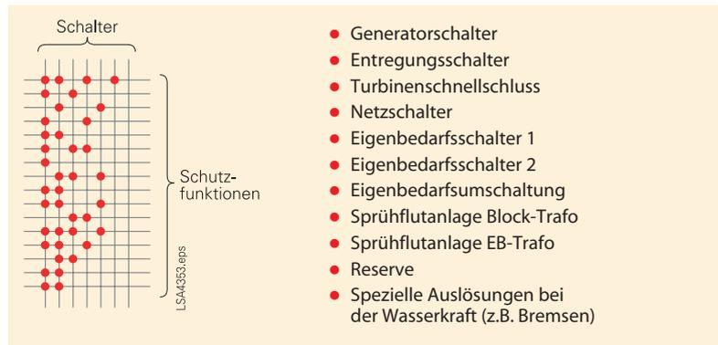
Bild 6 Schutzauslösung über die Matrix
